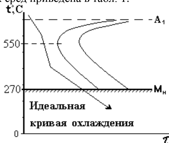
Рис. 3. Положение идеальной кривой охлаждения на диаграмме изотермического распада аустенита
