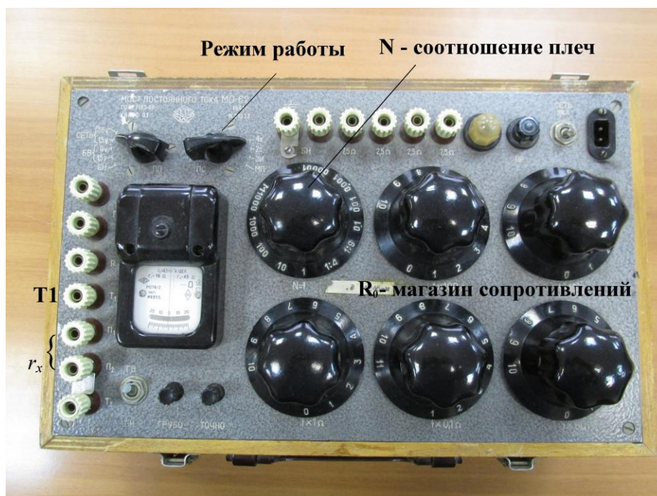
Рис. 3. Мост постоянного тока МО-62
